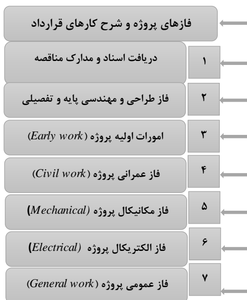
شکل ۳: بخش‌های اصلی قرارداد EPC پروژه نیروگاه خورشیدی ۲.۵ مگاواتی شرکت صنایع مس شهید باهنر
